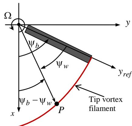
Fig. 2 tip vortex trajectory
